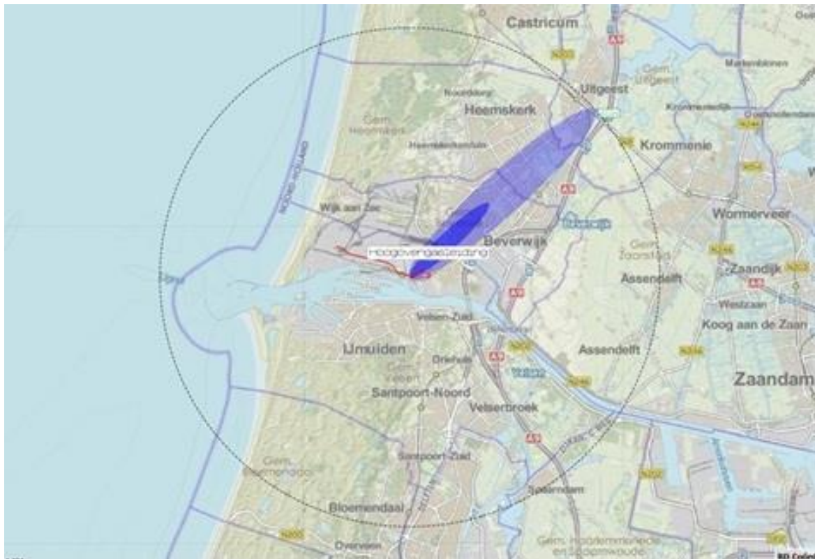
Figuur 9. Voorbeeld van een effectwolk na ca. 30 minuten, AGW in blauw, LBW in donkerblauw NB: ook afhankelijk van de daadwerkelijke locatie van de scheur in verband met de leidinglengte van 3 km.
